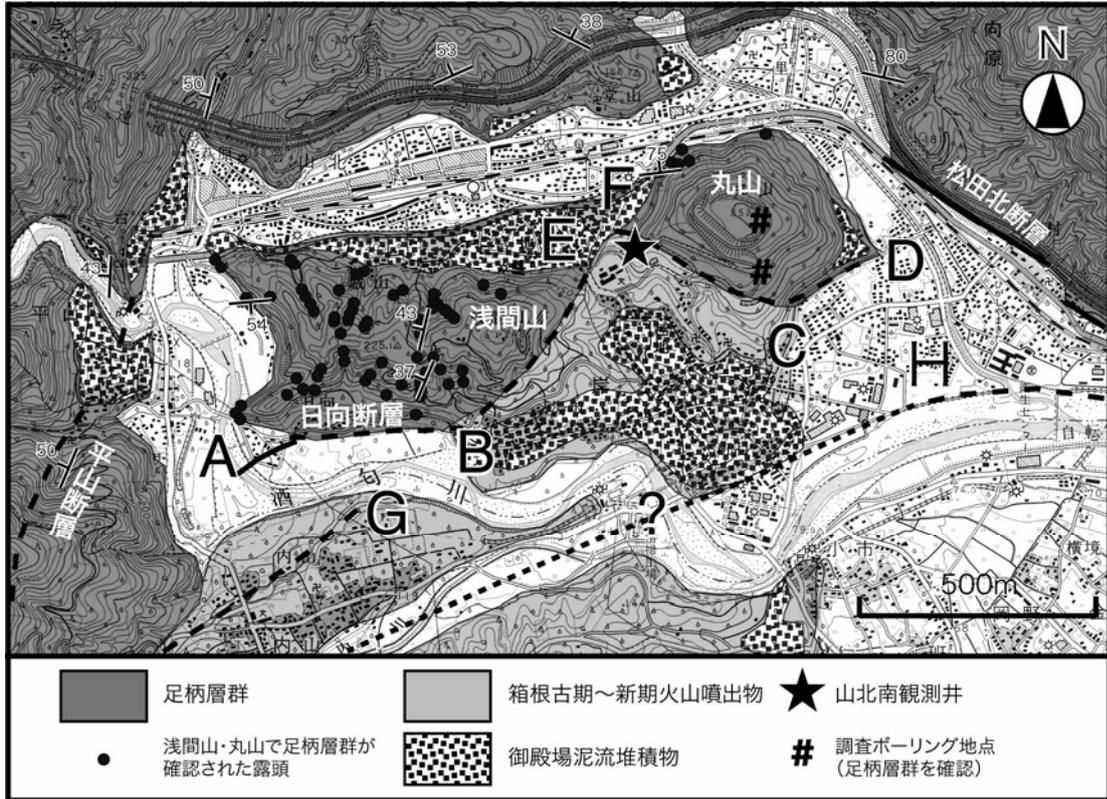
図29 山北南観測井(星印)周辺の地質図(林ほか,2007,印刷中)。地形図は1:25,000 国土地理院発行地形図「山北」を利用した。断層 B-E-F-C が本研究で新たに推定された第四紀断層である。断層 A は徐(1995)により発見された日向断層、G は今永(1999)による内川断層である。推定断層 H は、木村ほか(2004)および本計画による小田原-甲府測線によって存在が確認された。
