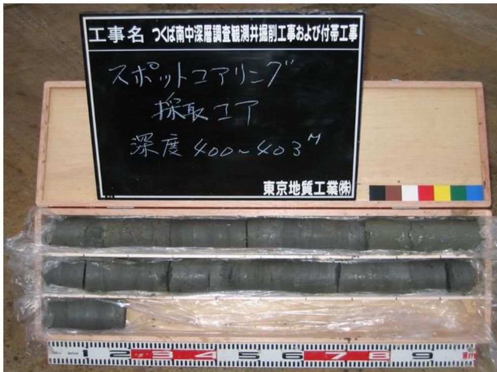
図9 深度 400m のコアサンプル (上総層群の炭質物を多く含む砂質シルト岩)
