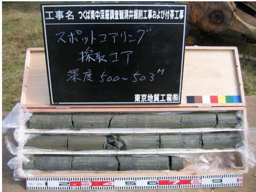
図10 深度500mのコアサンプル（上総層群の緑灰色塊状細粒砂岩）
